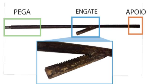
Figura 6- Ferramenta existente utilizada para arranque da mandioca
