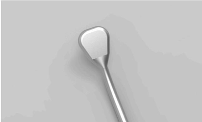
Figura 11- Ponta de enterramento do extrator manual de raízes de mandioca proposto
