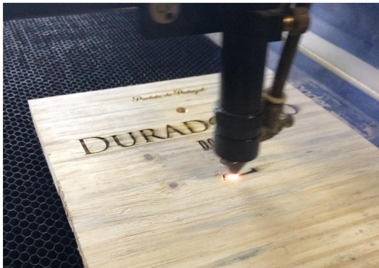
Figura 80. Marcação a laser na lateral da caixa
