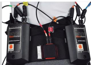
*Coloque os núcleos de ferrite logo acima da faixa colorida nos cabos da bateria.*
