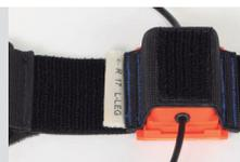
Fixar cada cinta no corpo com atenção ao alinhamento e simetria. A precisão da captura dos movimentos depende do **exato posicionamento dos sensores**. A posição dos cabos não interfere na captura dos movimentos.
