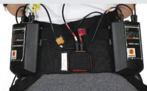
Posicionar a bateria direita e esquerda nas laterais das costas, na altura da cintura. **Realize a colocação das pilhas nas baterias.**
