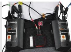
Coloque os núcleos de ferrite logo acima da faixa colorida nos cabos da bateria.
