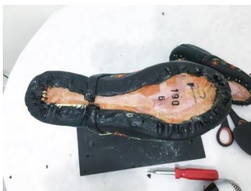
Figura 144: Colagem do solado
