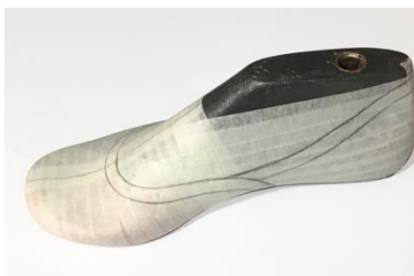
Figura 132: Fôrma com o desenho do cabedal Fonte: A autora
