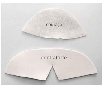
Figura 85: Couraça de fibra e contraforte de E.V.A. usados nos protótipos Fonte: A autora
