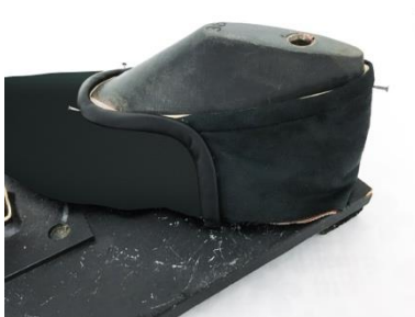
Figura 138: Cabedal pregado na fôrma Fonte: A autora
