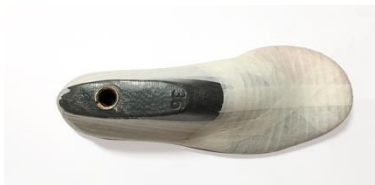
Figura 131: Fôrma encapada com fita crepe Fonte: A autora
