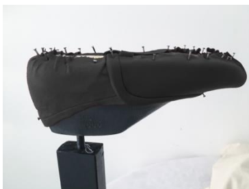
Figura 143: Colagem do restante do cabedal
