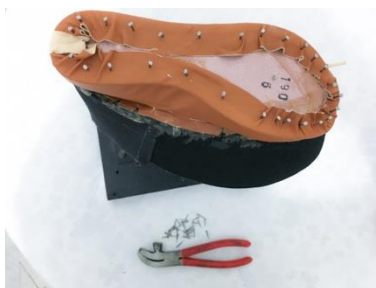
Figura 140: Colocação de pregos de fixação no forro
