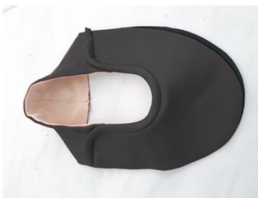
Figura 136: Cabedal com a costura finalizada Fonte: A autora
