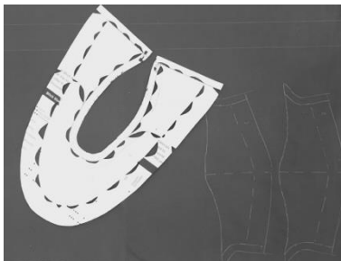
Figura 134: Marcação do molde no suede
