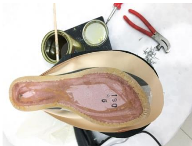
Figura 139: Colagem do forro na palmilha
