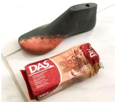
Figura 125: Moldagem de alteração da largura da fôrma Fonte: A autora
