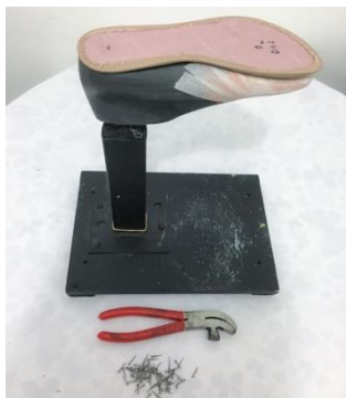
Figura 137: Palmilha pregada na fôrma Fonte: A autora
