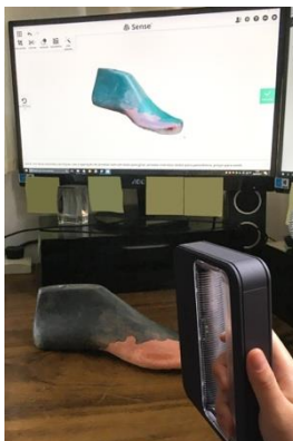
Figura 127: Escaneamento das fôrmas com o Sense Fonte: A autora
