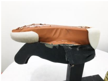
Figura 142: Inserção do contraforte e couraça
